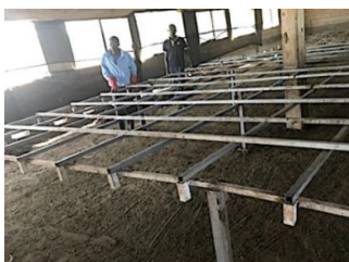
Grilles métalliques pour le séchage debout
